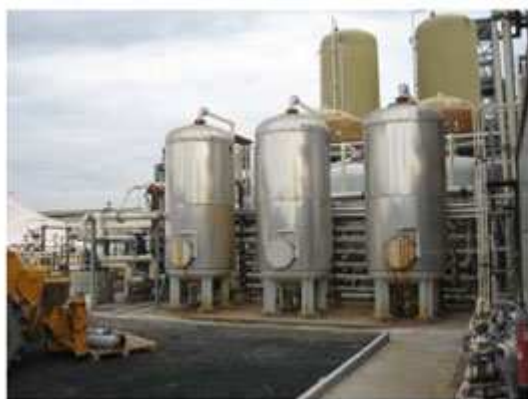
Stabilimento Altair: colonne adsorbimento rimozione calcio, magnesio, ecc. e modulo celle membrana
