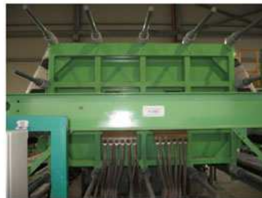
Stabilimento Altair: colonne adsorbimento rimozione calcio, magnesio, ecc. e modulo celle membrana
